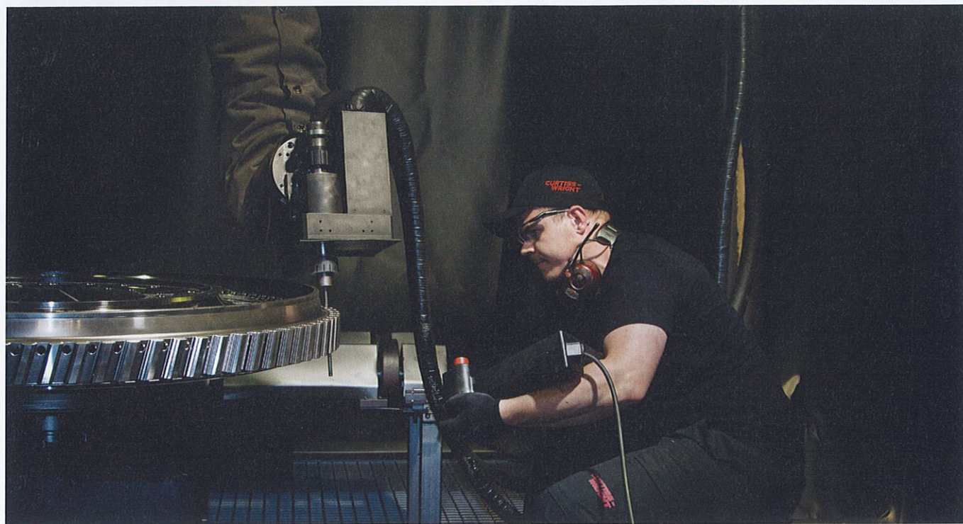
Tony Lundh verifierar robotprogrammet innan kulpning av skovelspar i en gasturbinskiva.
